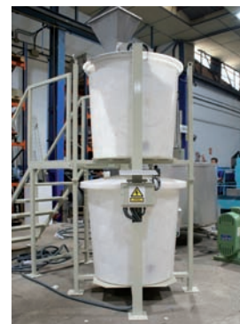
Depositos Mezcla Floculante Des réservoirs Mélange Flocculante Deposits Mix Flocculante
