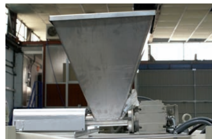
2 Deposito Floculante Floculante Doseur Flocculant Dispenser
